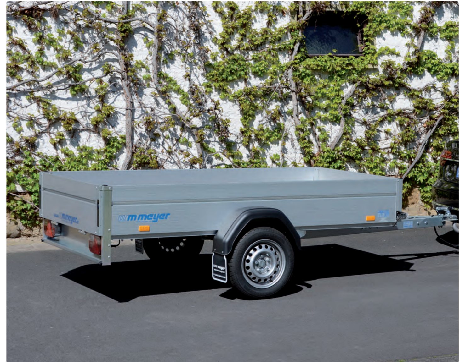
HZ 7525/126 V-Deichsel, Kunststoffkotflügel, Aluminiumbordwände eloxiert mit Sicke zur Planenbefestigung (Stärke: 25 mm, Höhe: 350 mm) HZ 7525/126 Timon en V, garde-boues en plastique, ridelles en alu anodisé avec rainure pour attacher une bâche (épaisseur : 25 mm, hauteur : 350 mm) HZ 7525/126 V drawbar, plastic mudguards, anodised aluminium side panels with seam to fasten canvas top (width: 25 mm, height: 350 mm)
