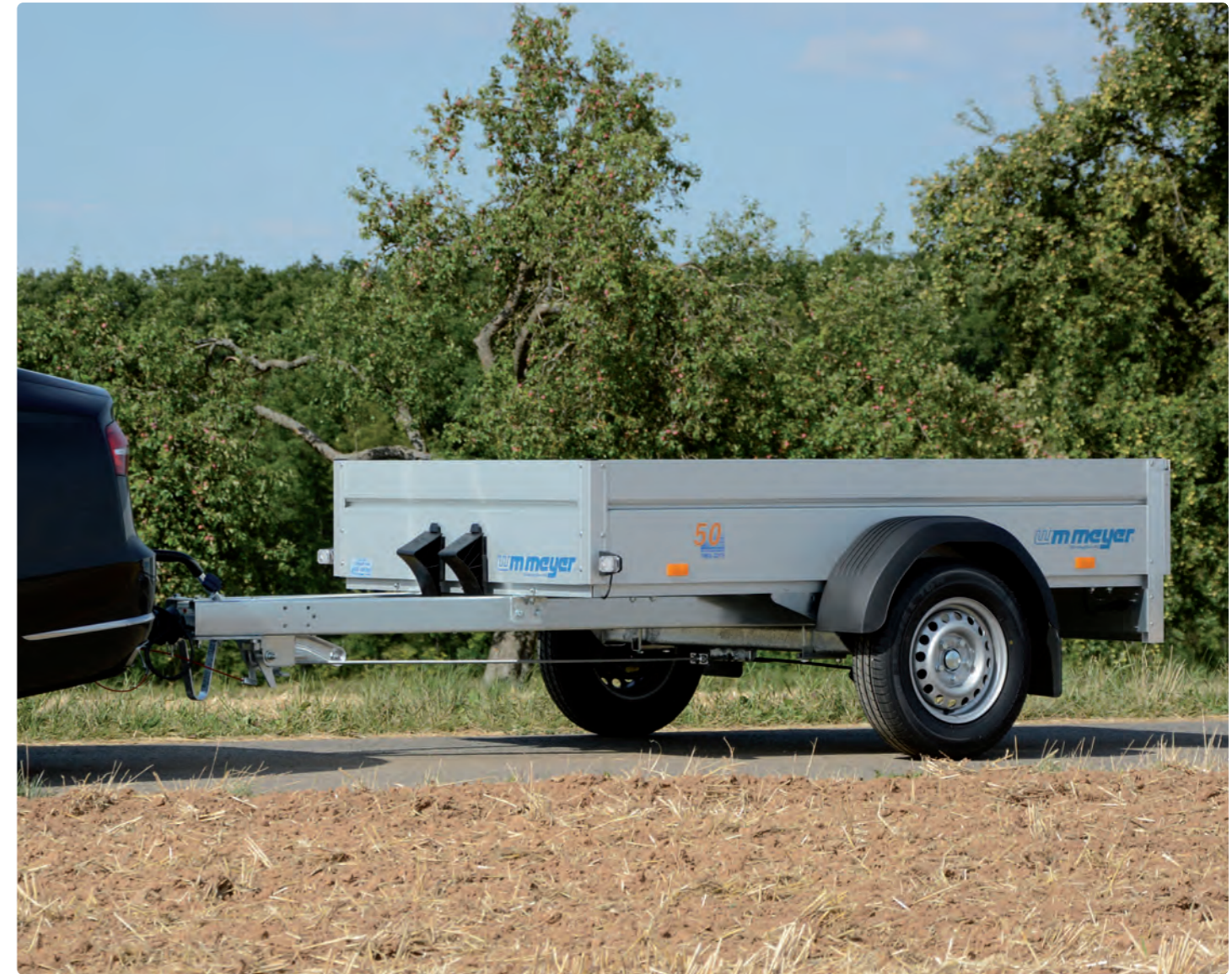
HZB 1021/126 Aluminiumbordwände (Höhe: 35 cm), Kunststoffkotflügel HZB 1021/126 Ridelles en aluminium anodisé (hauteur : 35 cm), garde-boues en plastique HZB 1021/126 Aluminium side panels (height: 35 cm), plastic mudguards
