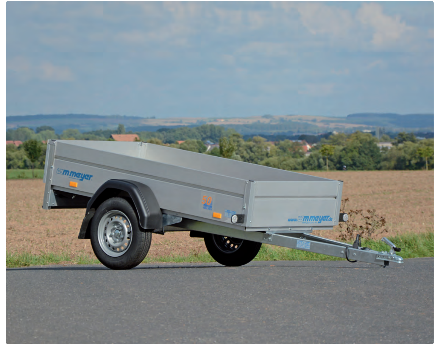
HZ 7521/106 V-Deichsel, Aluminiumbordwände eloxiert mit Sicke zur Planenbefestigung (Stärke: 25 mm, Höhe: 350 mm) HZ 7521/106 Timon en V, ridelles en alu anodisé avec rainure pour attacher une bâche (épaisseur : 25 mm, hauteur : 350 mm) HZ 7521/106 V drawbar, anodised aluminium side panels with seam to fasten canvas top (width: 25 mm, height: 350 mm)
